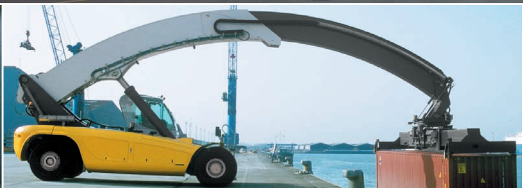
Im Einsatz unter Flur – ein weiteres Merkmal des Liebherr Reachstackers.
