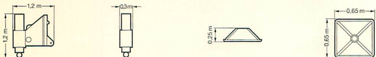
Hydraulische Abstützung für Selbstmontage / Hydr. jacks for self-erection / Support hydr. pour montage indépendant
