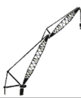
■ 40mブーム+5.65m+45mヘビーリフトジブ+15mエクステンションジブ (S性能)
