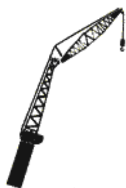
■40mブーム+25.5スーパーラフティングブーム+11mベースジブ+15mラフティングジブ (A性能)
