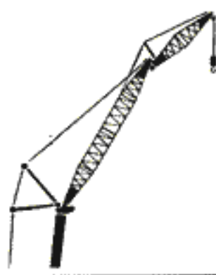
■ 40mブーム+5.65m+45mヘビーリフトジブ+15mエクステンションジブ (S性能)
