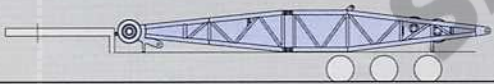
Top and root section lower luffing mast / Spitze und Fuß Wippstütze unten / Pointe et pied de contre-flèche inférieure
